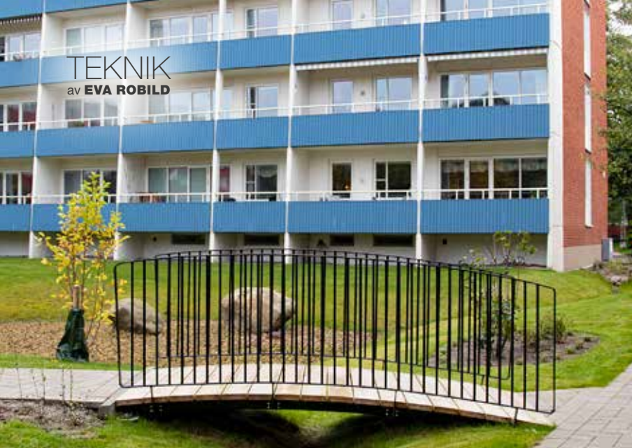
En bro mellan husen och parkering leder över ett gräsbeklätt så kallat svackdike där vattnet långsamt kan rinna mot dammen.
